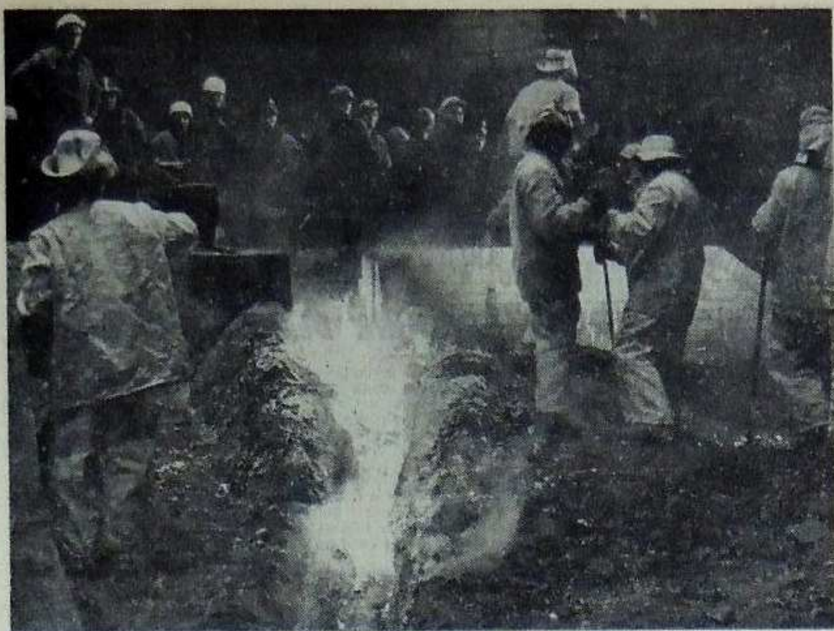
Pierwszy spust surówki w Hucie Katowice. To było tak niedawno, a przecież od tamtego czasu było już tych spustów ponad 700.
